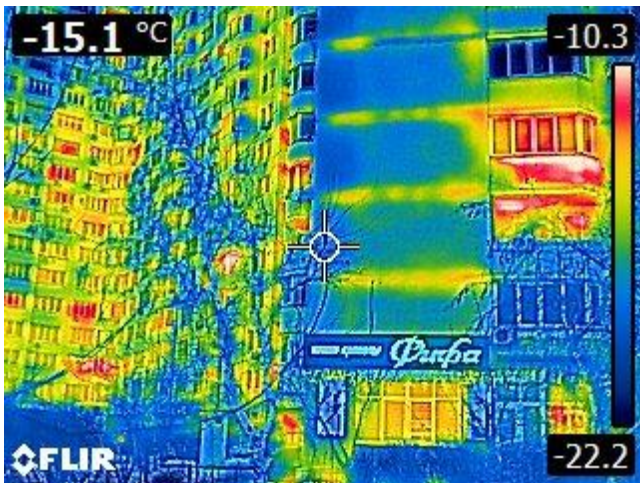
Тепловтрати через місця теплопровідних включень (на стиках панелей)
